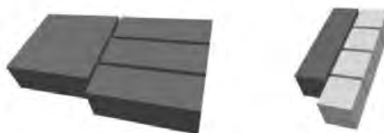
Figura 14. Exemples de col·locació incorrecta de peces.
